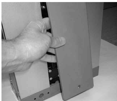
3. 向外拔出端盖并向下取出。
