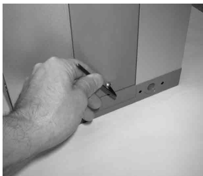
6. 重新安装固定螺丝（拧紧力矩最大为 1 Nm）。
